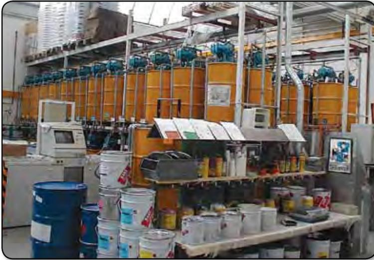
Bombas de válvula de bola de 1" instaladas en una operación de mezcla de pintura y coloración.
