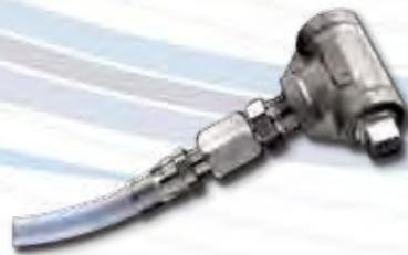
**DETECTOR VISUAL DE FUGAS:** Se instala un detector de fugas tipo tubo indicador en cada cámara del impulsor. Si se provoca una ruptura del diafragma de bombeo, el líquido del tubo indicador cambia.
