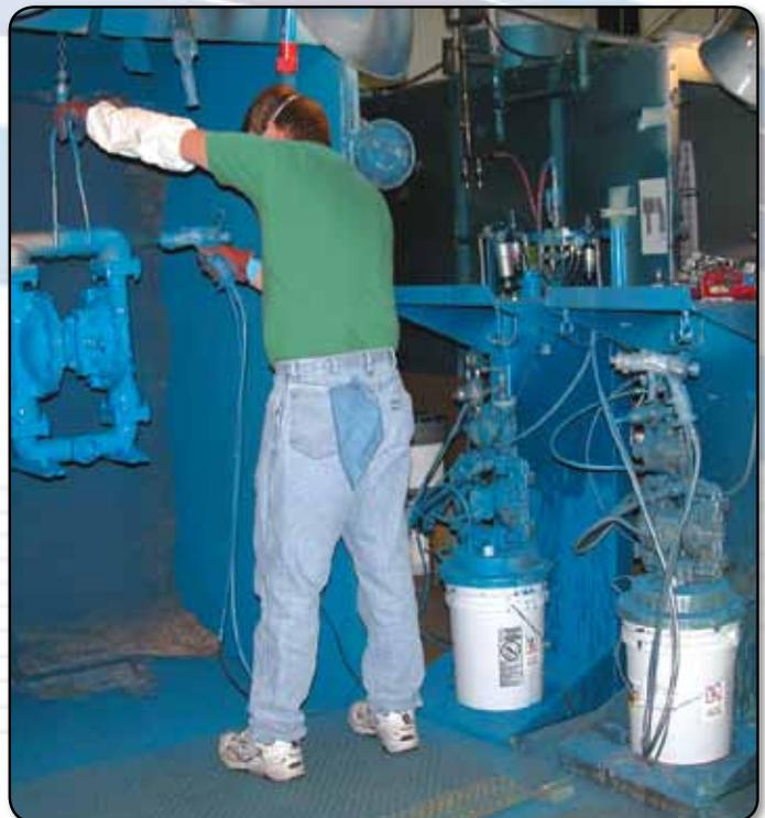
Bombas SANDPIPER® montadas en cubo instaladas en estaciones de cabinas de pulverización de pintura.
