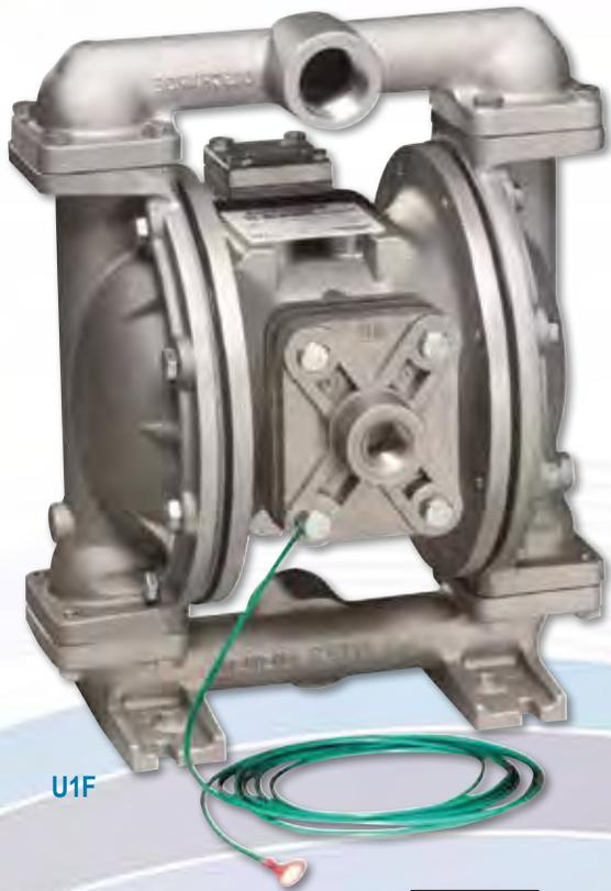
Las bombas UL (Underwriters Laboratory) están diseñadas para cumplir las normas UL79 para bombas de diafragma que manipulan líquidos inflamables. Fabricadas completamente de aluminio con nitrilo aprobado o elastómeros UL de PTFE virgen. Se puede conectar completamente a tierra para evitar una descarga estática.
