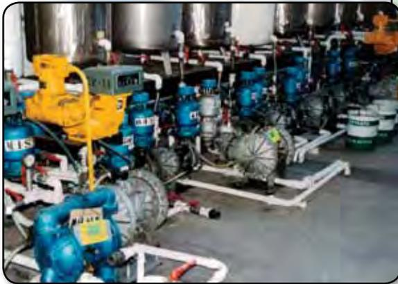
Bombas de uso de contención metálicas y tranquilizadores instalados en una planta de procesamiento de productos químicos.
