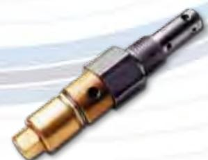
**DETECTOR MECÁNICO DE FUGAS:** Cuando una fuga ataca químicamente a una junta tórica de este detector, acciona un émbolo. Esto abre una válvula de aire que, a su vez, activa un solenoide (o un dispositivo similar) suministrado por el cliente para generar una señal.
